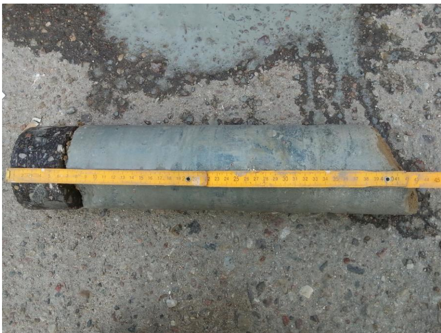
Fot. 2 Rdzeń pobrany z nawierzchni w otworze nr 1.
