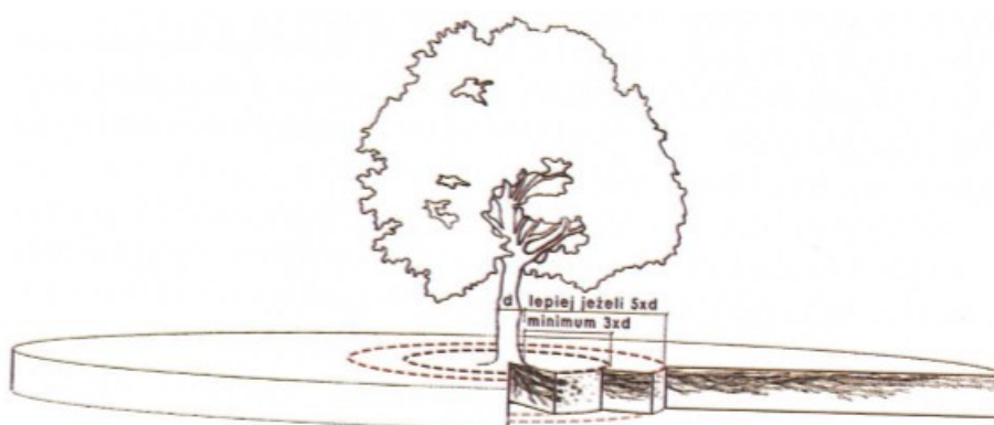
Rys. 4. Minimalna odległość cięcia korzeni ze względu na statykę drzewa od pobocznicy pnia (Smiley 2008, rys. Świder)
