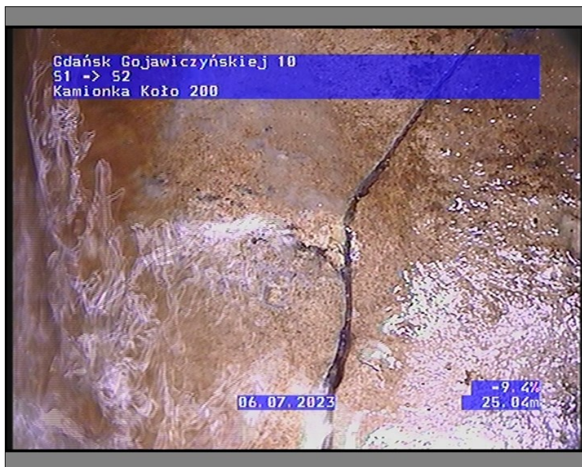
Zdjęcie: 1_6A 25,03m, Wzdłużnie po kierunku przewodu, na 5 godz.
