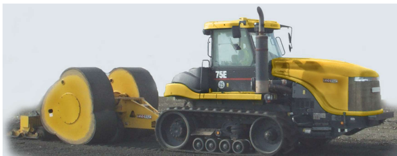
Rys. 6 Walec dynamiczny holowany przez ciągnik gąsienicowy
