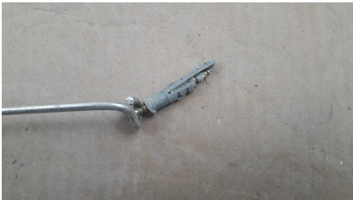
Rys. 3.4. Zbliżenie na zniszczony kolek szybkiego montażu zastosowany do zakotwienia sufitu podwieszanego
