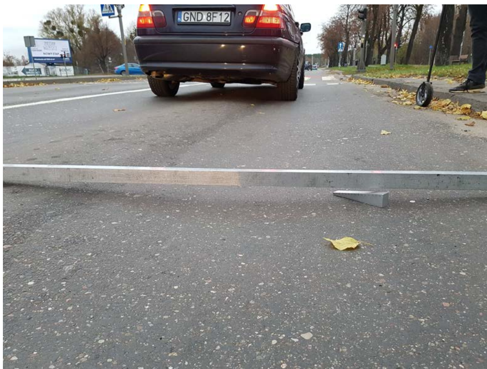
Fot. 29. Przykład stwierdzonych deformacji istniejących warstw bitumicznych na Al. Hallera, odc. od ul. Kościuszki do Al. Płacyńskiego, jezdni w kier. Brzeźna, pas prawy (km 1+237) – stwierdzona głębokość koleiny: 50 mm
