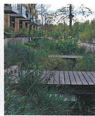
Utworzenie w zagłębieniu suchej rzeki - obsadzonej bylinami i krzewami znoszącymi tymczasowe zalewanie.
