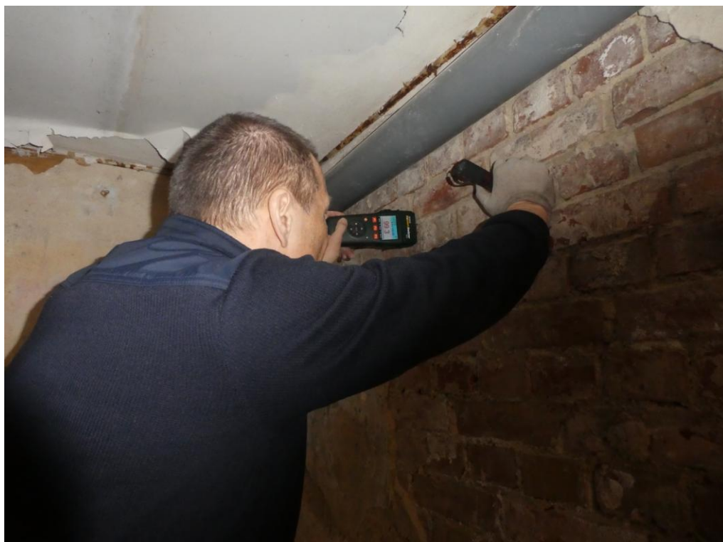
Fot. Pomiar wilgotności względnej w górnej partii ściany zewn. zach. 99,3%
