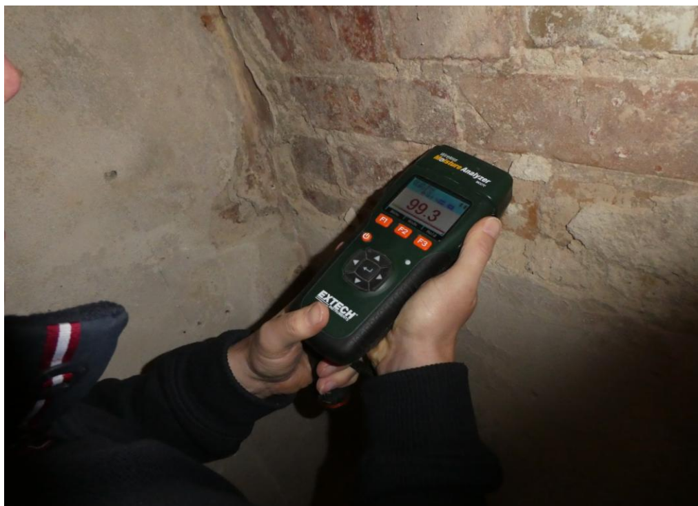
Fot. Badanie poziomu wilgotności względnej wyższej partii ściany od strony ul. Batorego 99,3%
