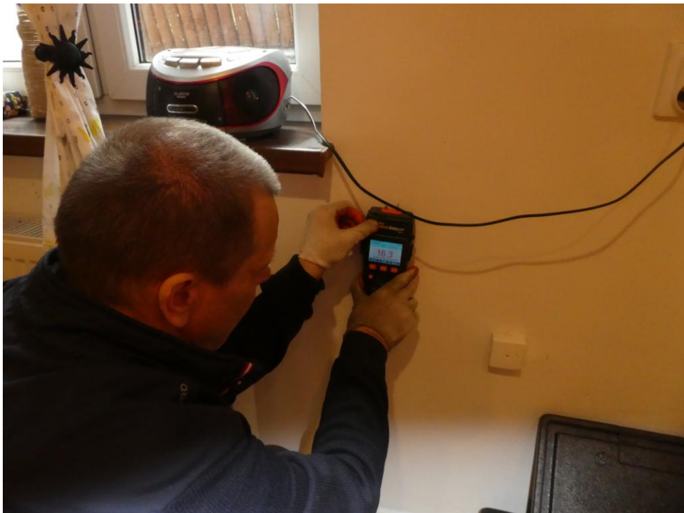
Fot. Badanie wilgotności ściany zewn. na wys. ok. 50cm pom. 1/B_0: 16,3%
