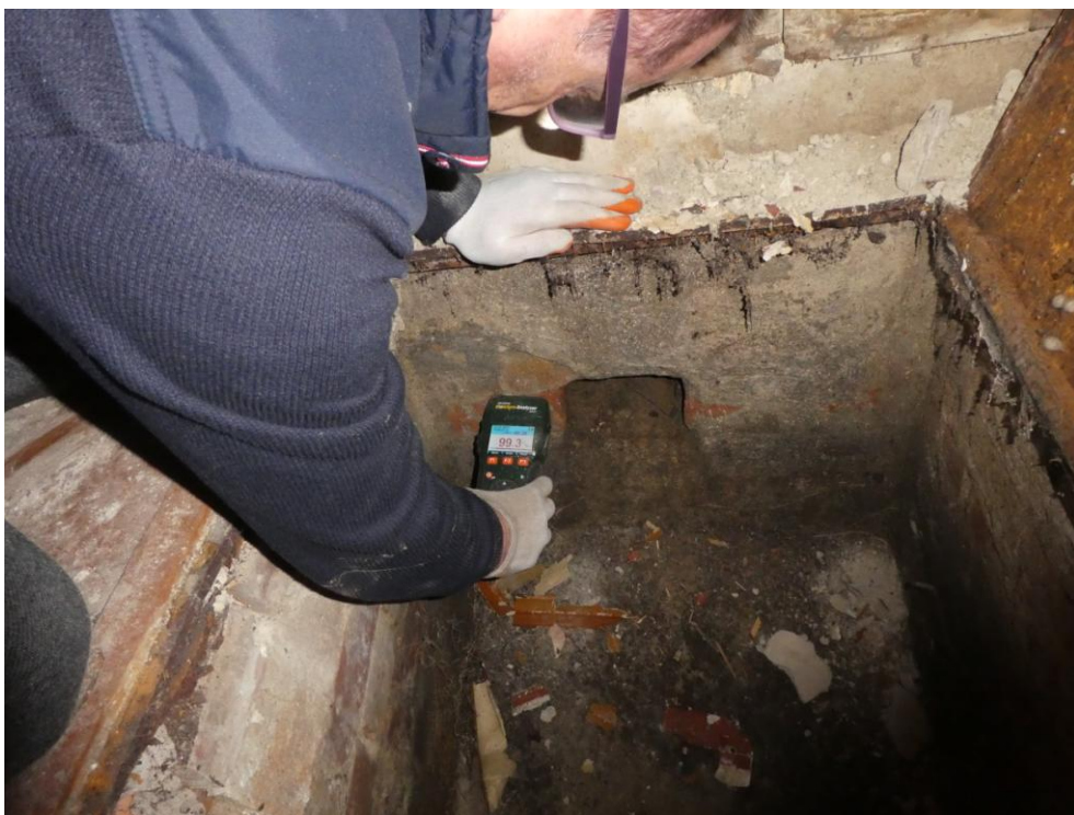
Fot. Wilgotność ścianek kanału 99,3%
