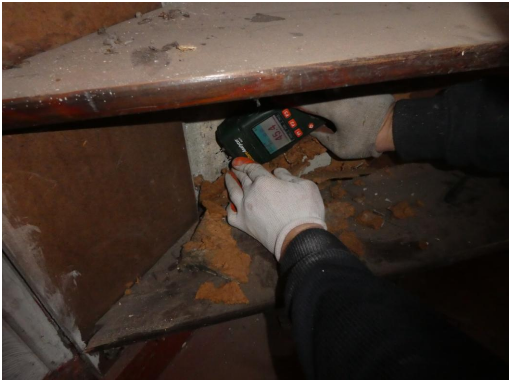
Fot. Pomiar wilgotności w/w ścianki za szafką 45,4%
