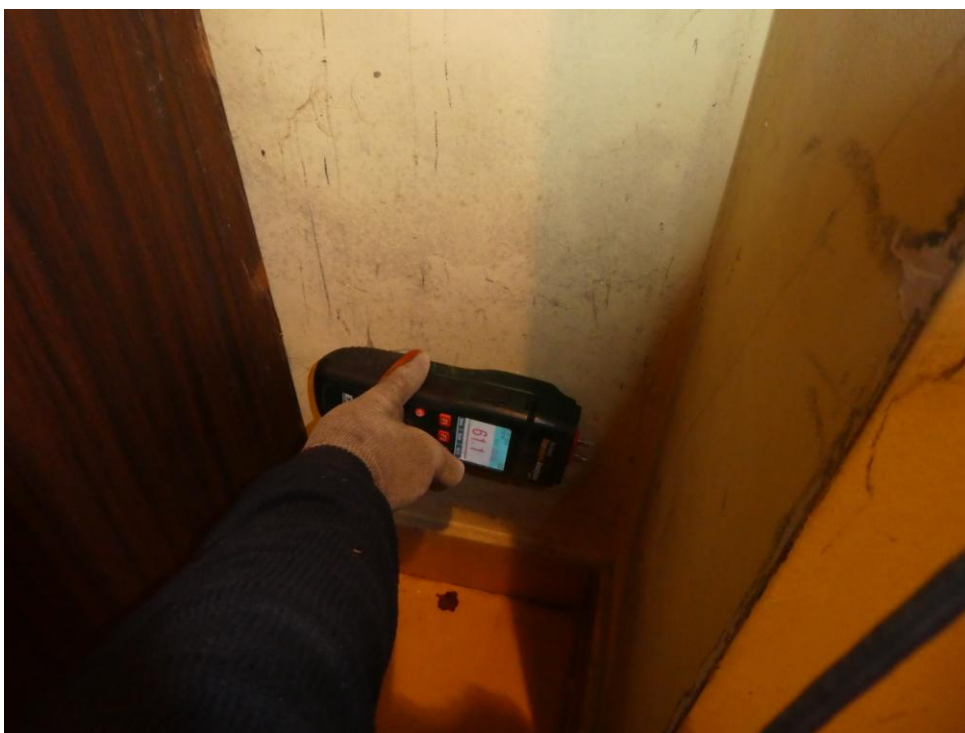
Fot. Badanie wilgotności ściany zewn. magazynku 61,1%
