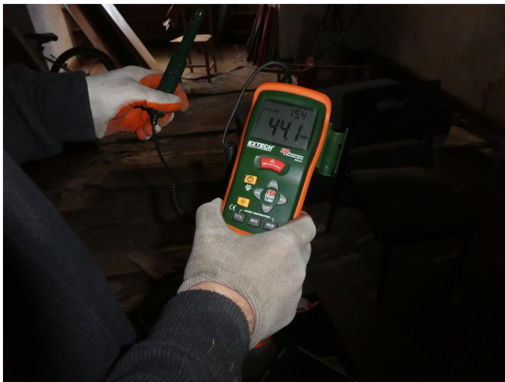
Fot. Pomiar wilgotności względnej powietrza 44,1% przy temp. 15,4°C
