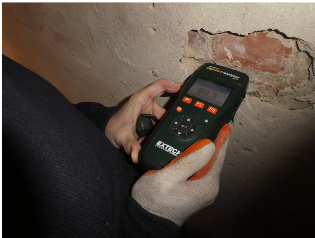
Fot. Pomiar wilgotności spoiny w ścianie zewn. od strony zachodniej 99,3%
