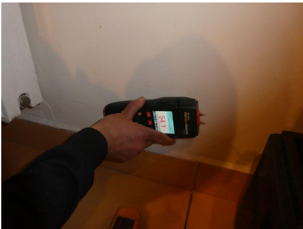
Fot. Badanie wilgotności ściany zewn. pom. 1/B_0: 54,1%
