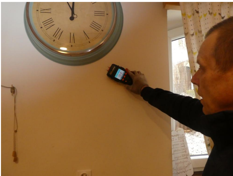
Fot. Badanie wilgotności wyższych partii ściany zewnętrznej pom. 1/B_0: 15,4%
