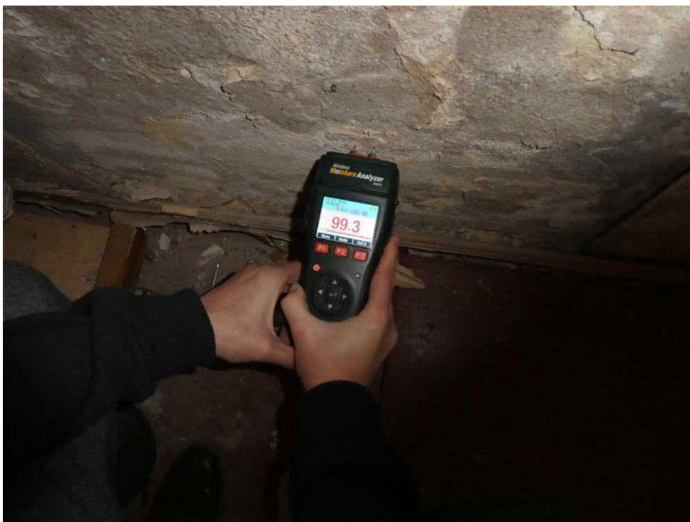
Fot. Badanie poziomu wilgotności względnej w/w ściany 99,3%
