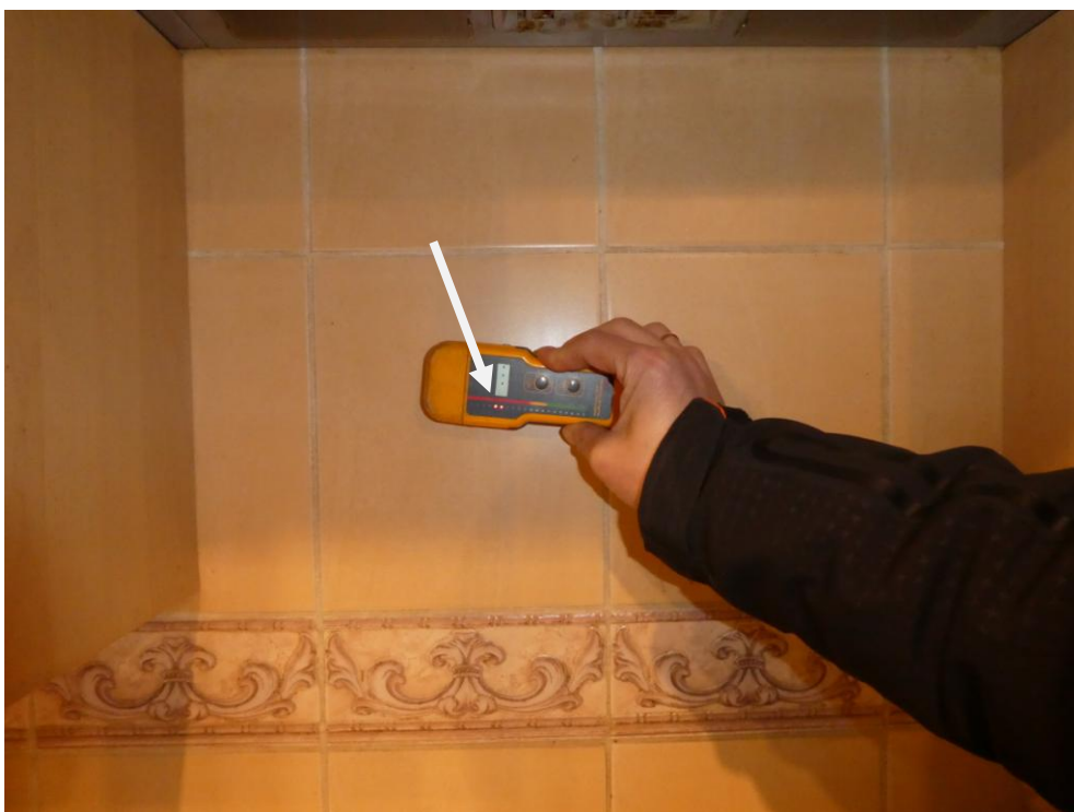
Fot. Czerwone świecące diody wskazują na wysoki poziom wilgotności pod płytkami na ścianie pomiędzy szafkami kuchennymi (po. 1/B_0)
