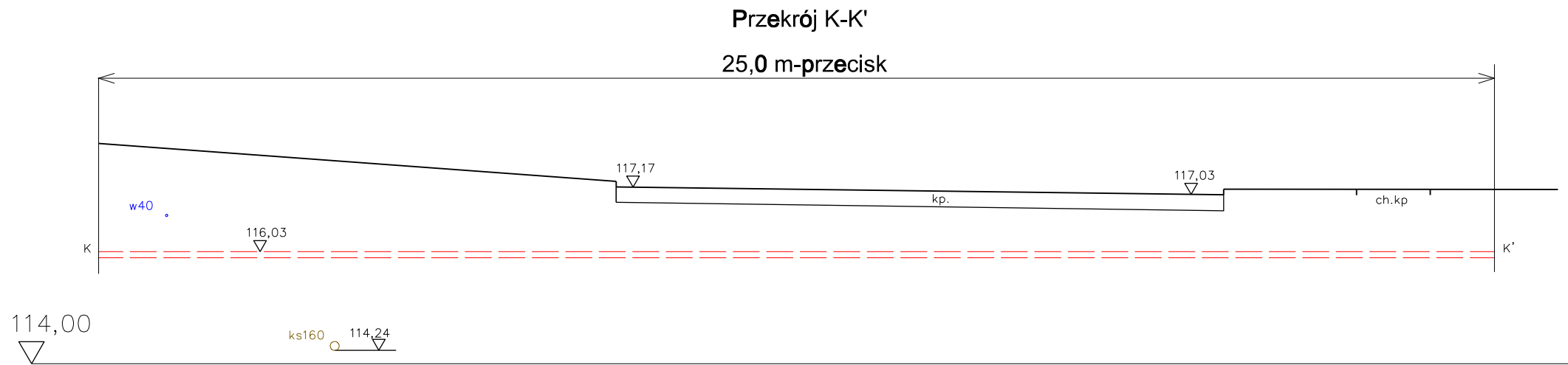
Przecisk rurą typu RHDPEp 110/6,3mm
