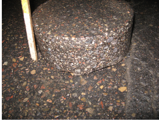
Fot. 7. Rdzeń pobrany z otworu nr 4 (asfalt)
