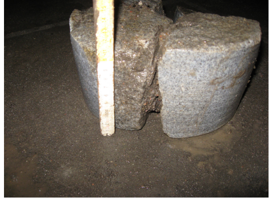
Fot. 8. Rdzeń pobrany z otworu nr 4 (bruk)
