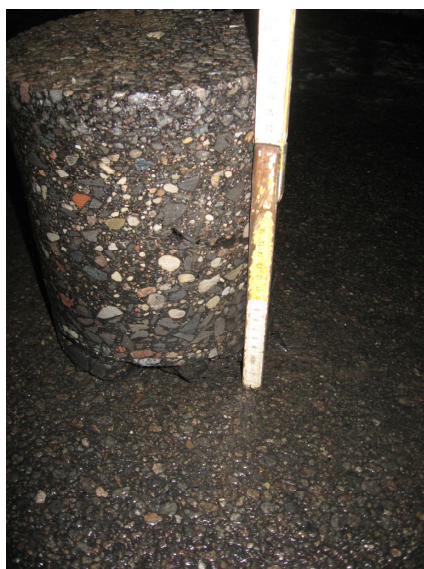
Fot. 1. Rdzeń pobrany z otworu nr 1
