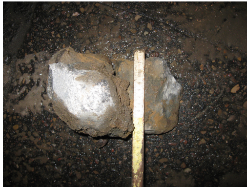
Fot. 9. Rdzeń pobrany z otworu nr 4 (bruk)
