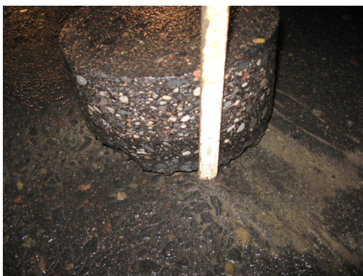
Fot. 5. Rdzeń pobrany z otworu nr 3
